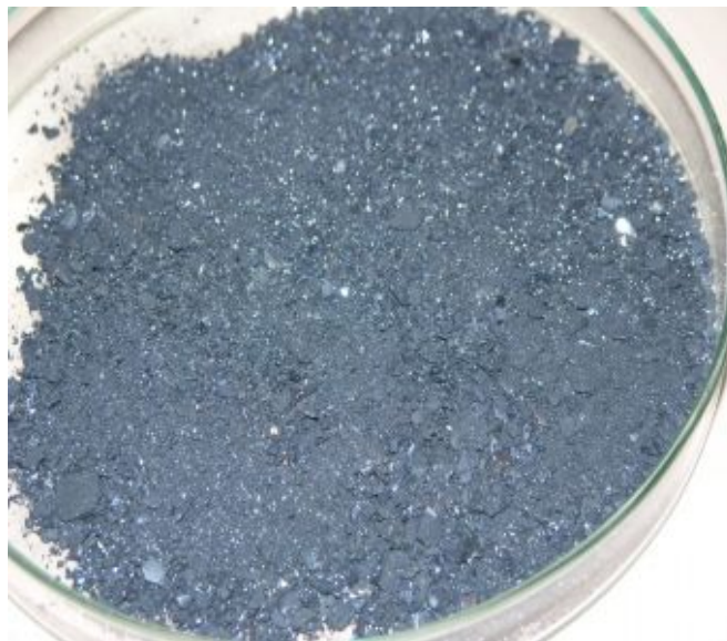
Ilustracja 2. Nanocząstki srebra w otoczce parafinowej otrzymane metodą termiczną rozkładu związków srebra w atmosferze beztlenowej
